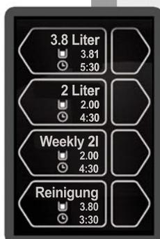
Bis zu 4 Brühprogramme können in der Maschine individuell gespeichert und benannt werden. Das macht die Bedienung der Maschine denkbar einfach und sorgt stets für frischen Filterkaffee.
